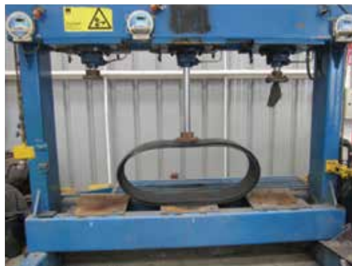
IMÁGENES DE LOS ENSAYOS DE RIGIDEZ, TENSIÓN Y HERMETICIDAD EN LA SOLDADURA.
