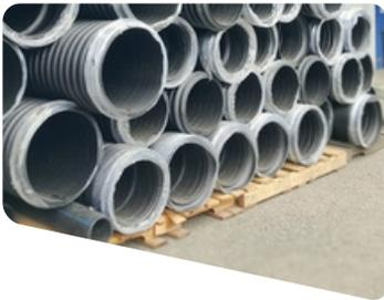
El terreno donde será apoyada la primera capa de tubos debe ser uniforme y firme para evitar posibles daños en la superficie externa y flexiones longitudinales.
