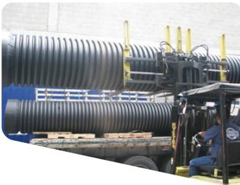
No se debe manipular la tubería con ganchos en los extremos, para evitar daños o causar curvaturas excesivas por el ángulo de tiro.
