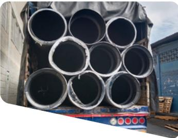
Para proteger las tuberías de altas temperaturas cuando se transporta por largos periodos, se debe dejar un espacio entre la cubierta y la tubería para permitir la circulación de aire y así evitar deformaciones ocasionadas por el peso de la tubería y la temperatura existente.
