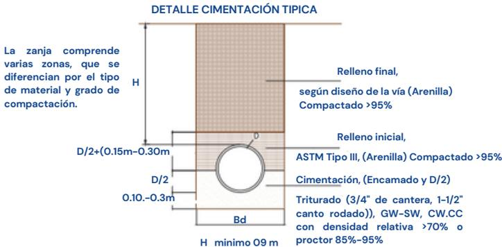
Se recomienda abrir únicamente la longitud de zanja que se pueda mantener bajo condiciones seguras y estables. Una vez instalada la tubería, realizar el lleno de la zanja tan pronto como sea posible, para disminuir el riesgo de que la tubería sufra algún daño, además se evitan inundaciones en la zanja y daños en el material de encamado, y que se desestabilicen los taludes.
