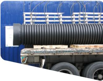
Vehículo con la superficie de carga lisa, sin elementos que puedan dañar la tubería.
