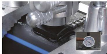
8 Dejar enfriar la unión por un mínimo de tres minutos antes de retirar la herramienta de aplicación. Esperar al menos 1 hora más antes de realizar las pruebas de presión o derivar de la tubería principal.
