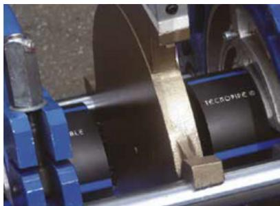
7 Limpie las caras de la tubería con alcohol isopropílico utilizando un paño limpio y libre de pelusas.
