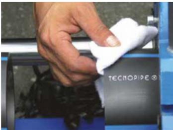
5 Verifique el alineamiento utilizando un dispositivo adecuado. Se permite una desalineación máxima del [indicar el valor en las especificaciones técnicas]
