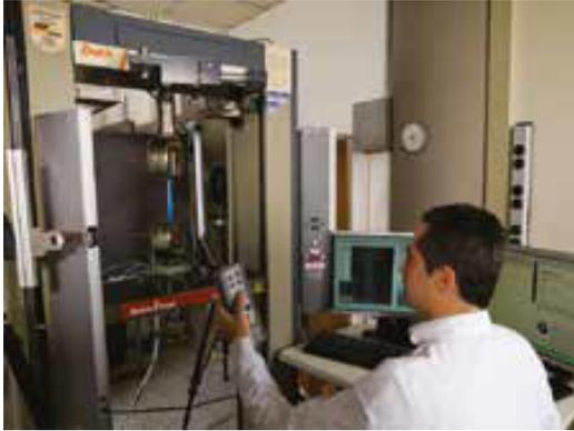
Esta evaluación abarca la presión era bajo, la reversión longitudinal para determinar las contracciones provocadas por cambios de temperatura, la velocidad de propagación de grietas y la elongación a la rotura para evaluar la elasticidad del material, entre otros parámetros técnicos relevantes.
